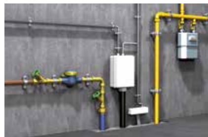
Fissaggio delle condotte
